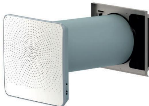
Ideal para proyectos de rehabilitación con poco espacio disponible, el Siber® DF RENOVAIR funciona según el principio de insuflación y extracción controladas de aire en estancias secas, complementado con extracción controlada en las estancias húmedas. El calor del aire extraído está recuperado en el intercambiador de calor para calentar el aire insuflado.
